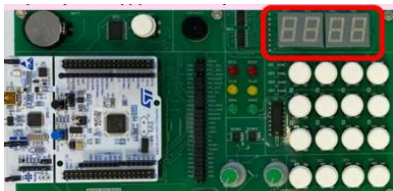
Рисунок 8 4 семисегментных индикатора, соединенных по схеме с общим катодом в составе ПМК «Электроника»
