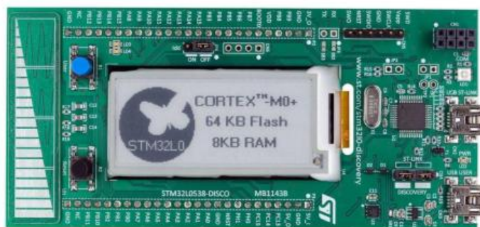
Рисунок 19 Отладочная плата STM32L0538 Discovery (Discovery kit), представленная ST в 2015 году
