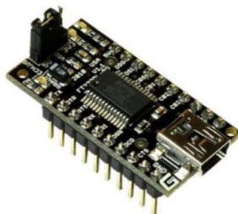
Рисунок 4 Типовая схема на базе FT232RL, используемая для преобразования 3,3 В TTL интерфейса UART в интерфейс USB
