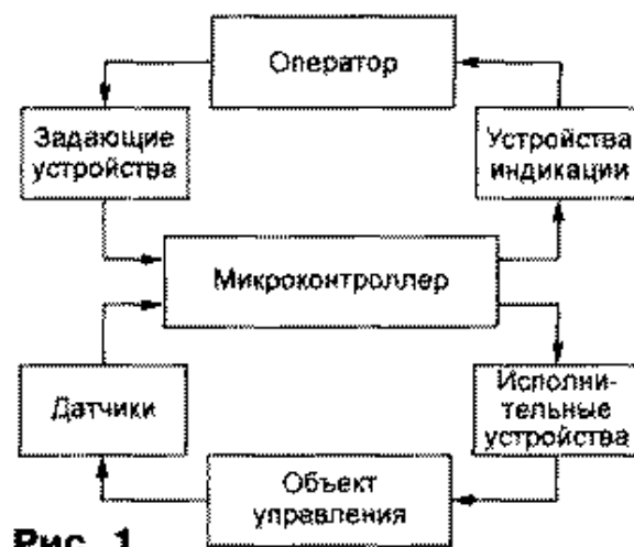
Рисунок 1 Взаимодействие любой МК-системы с оператором и объектом управления
