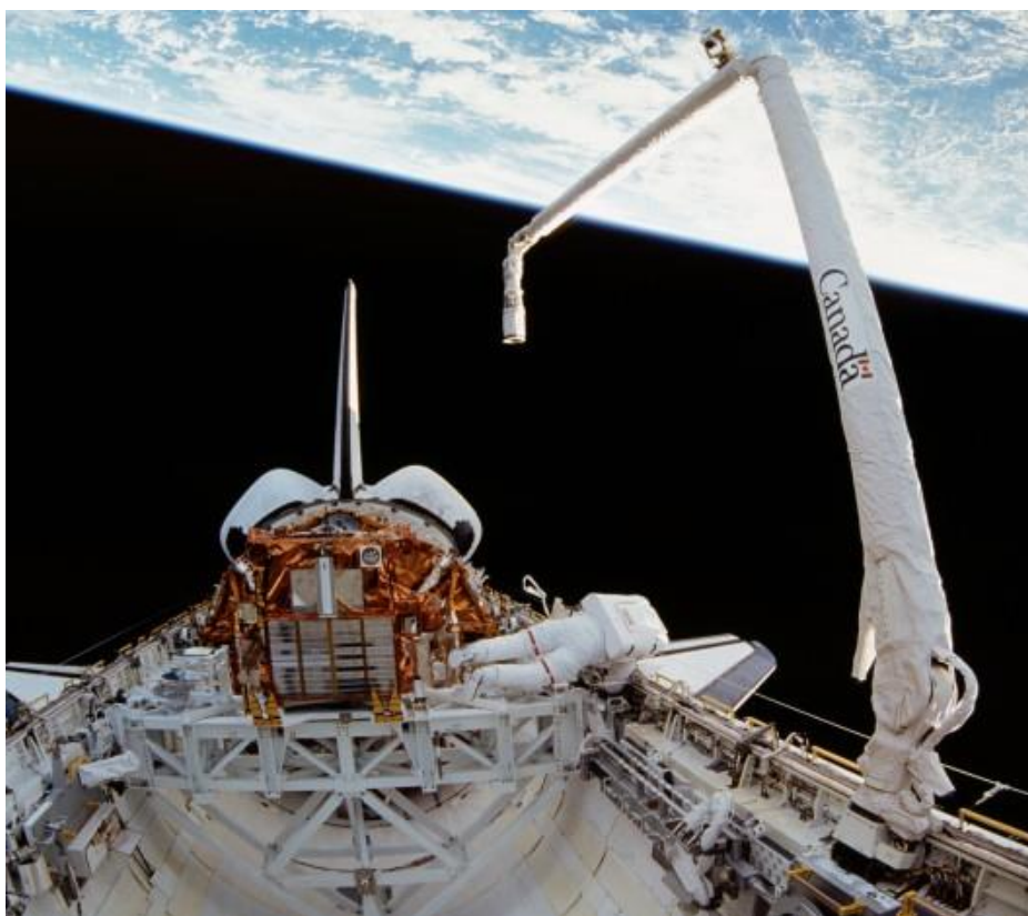
Рисунок 7 –Космонавты проводят работы с помощью манипулятора
