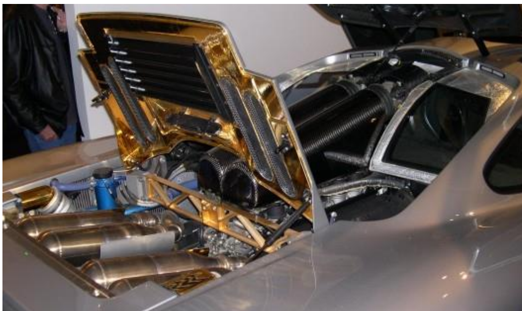
Рисунок 11 – Тепловая защита деталей автомобиля из золотой фольги
