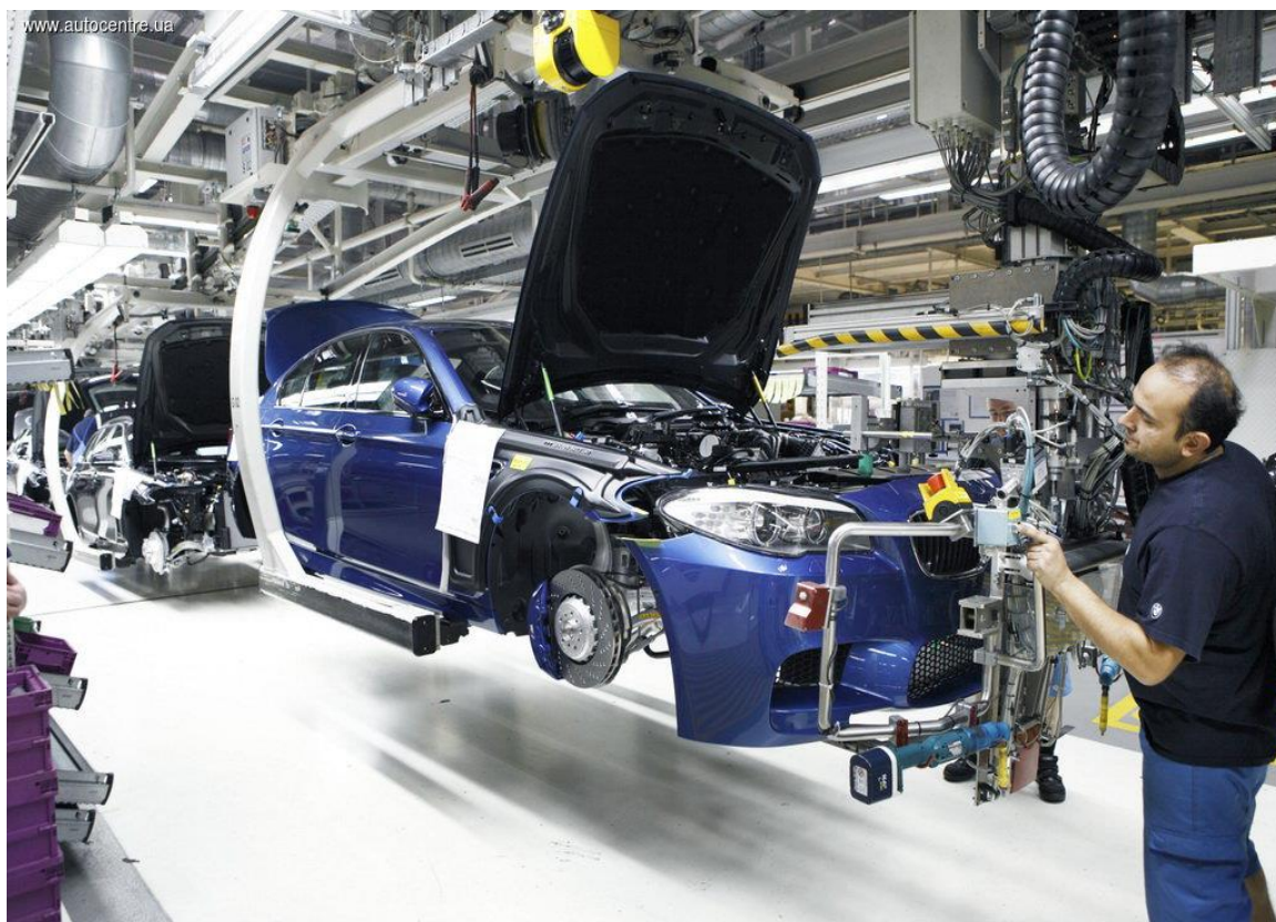
Рисунок 9 –Манипуляторы облегчают процесс сборки автомобилей
